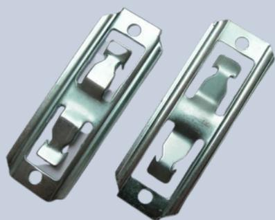
Emenda estampada em aço mola, temperado e zincado ou fosfatizado. Utilizada para fixação de forro, para evitar qualquer movimentação causadas por eventos climáticos. Pode ser utilizada em Forro Mineral, Isopor, PVC, e em placas de 20mm Para fixação de forros da linha T leve para unir dois perfil através do topo. Disponível em caixas com 1.000 peças, em embalagens de 100 peças cada.
